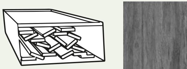
Questa Struttura dà origine a quello che viene chiamato pavimento in bambù Strand Woven Hi Density. Questa tipologia è caratterizzata dalla dispersione dei classici nodi delle canne di bambù dando origine al pavimento più resistente di tutta la gamma rendendolo particolarmente idoneo ad ambienti ad alto traffico.
