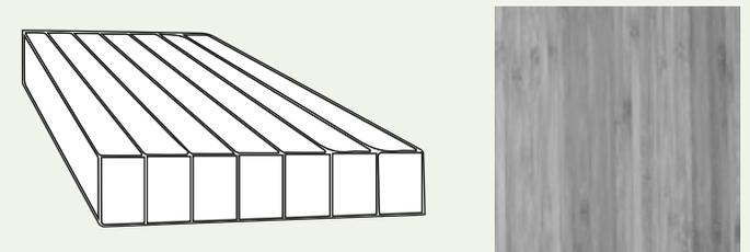
Questa Struttura dà origine a quello che viene chiamato bambù Verticale, soprannominato anche pavimento in bambù a nodo stretto. Questa tipologia è caratterizzata dalla conformazione di piccoli nodi.
