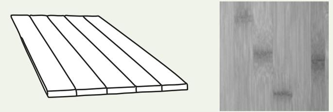
Questa Struttura dà origine a quello che viene chiamato bambù orizzontale, soprannominato anche pavimento in bambù a nodo largo. Questa tipologia è caratterizzata dalla evidente conformazione di ripetuti nodi.
